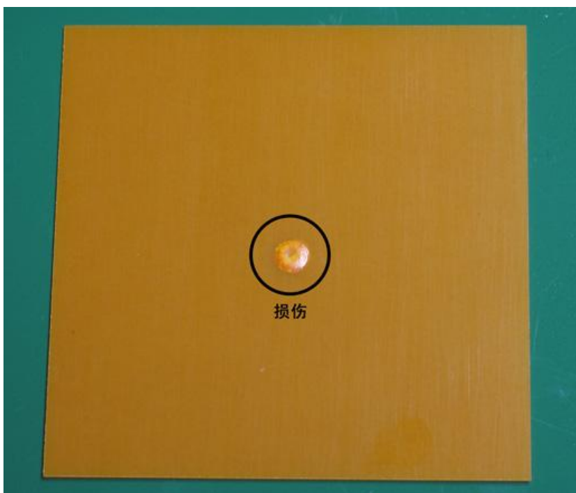
照片 3 (c) 仅仅 10 秒钟之后， 苯酚层压板就发生了变形
