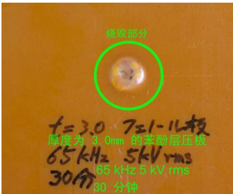
照片 4 (c) 厚度为 3.0mm 的苯酚 层压板烧焦
