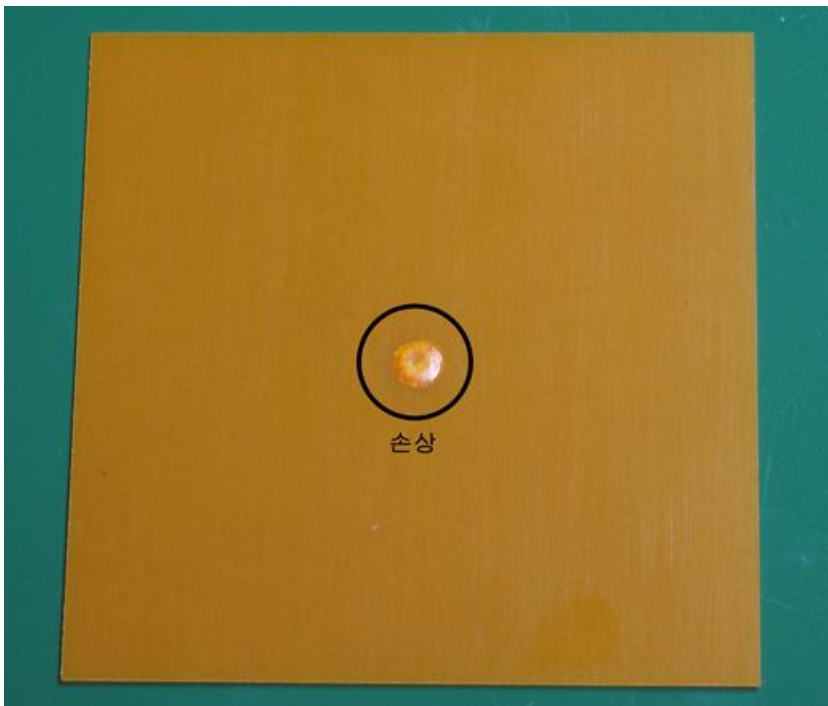
사진 3(b) 갭에 두께 1.0mm 의 페놀적층판을 끼워서 불꽃방전을 방지하였지만...
